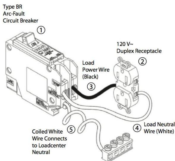
на котором показано, что его зона обслуживания – одна сдвоенная розетка. Конечно, нет оснований ожидать, что в такой цепи сигналы от искрения не дойдут до УЗДП. Но до УЗДП с большим номинальным током, обслуживающего площадь 100 кв.м и более со стандартным набором приборов, например, коттеджа, эти сигналы, по нашим измерениям, доходят уже заметно слабее, чем в любых испытаниях по стандарту. Отсюда и возникла идея имита-
